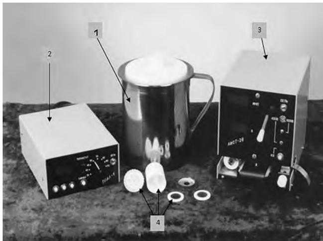
Рис.1 - Фотография прибора для травления трековых детекторов - термостат ТРАЛ-1 (1- травильное устройство; 2-электронный блок), прибора для автоматического истрогового счета треков АИСТ-2В (3) и радонметра (4)
